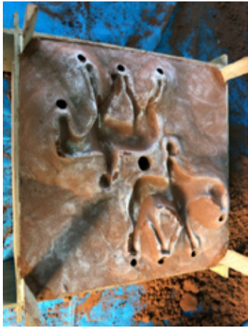
fig.14 下型の湯道変更
