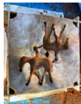
fig.13 上型の湯道変更
