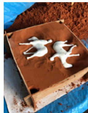
fig.12 原形の配置位置変更
