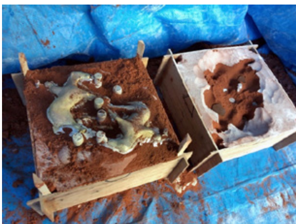
fig.9 上下の型枠外し
