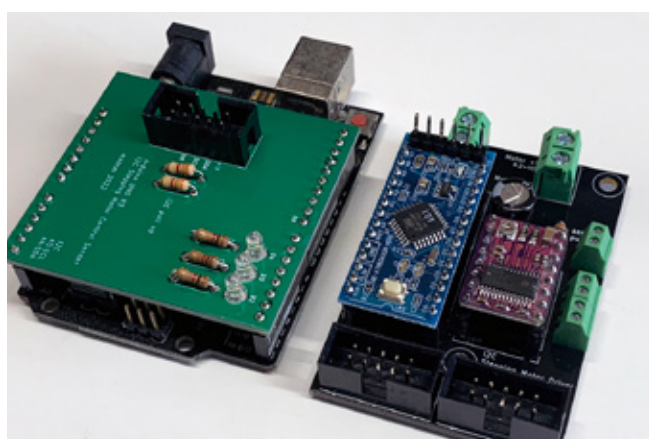
fig.4 Arduino UNOのマスター基板とArduino Pro Miniのモータコントロール基板
