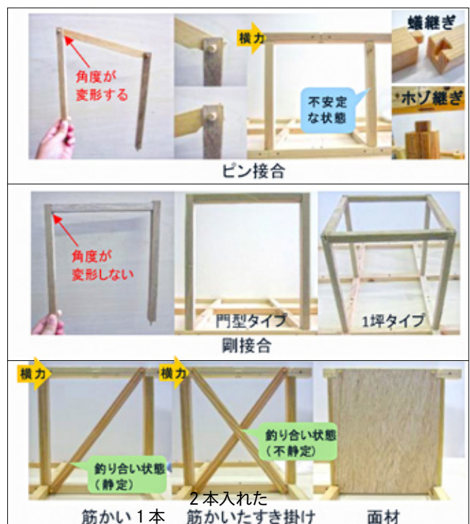
fig.1 1/10模型でピン接合と剛接合の比較
