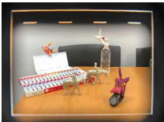
10 ライカ Ig 型（1960 年製造）外付け 3.5cm ファインダーから被写体を見る。撮影範囲より広い視野の中に反射光で光る枠線（ブライトフレーム）が浮かび上がり、近接撮影時の撮影範囲誤差（パララックス）を補正する点線も表示されており、少しずつ正確な撮影範囲が把握しやすくなっている。
