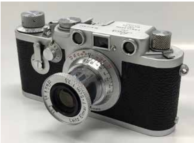
5 ライカⅢ f 型（1956 年製造）距離計が内蔵されたが、撮影範囲を決めるファインダーと距離計は分離している。距離計とレンズ距離目盛りの動きが連動したため、発表当時はこれを「オートフォーカス」と呼んだ。
