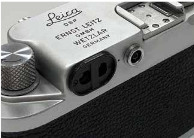
6 ライカⅢ f 型（1956 年製造）後方から見たファインダー部分の拡大。左側情報にある黒い楕円形部分に左側距離計と右側ファインダーの覗き窓が付いている。ファインダーの見え方は、ライカスタンダードとほぼ同様である。
