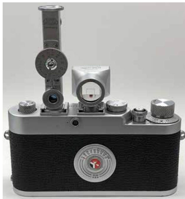
12 ライカ Ig 型（1960 年製造）外付け縦型距離計の円盤を回して内部の二重像を合致させ、その時の数値を読み取り、レンズの距離目盛りと合わせる。
