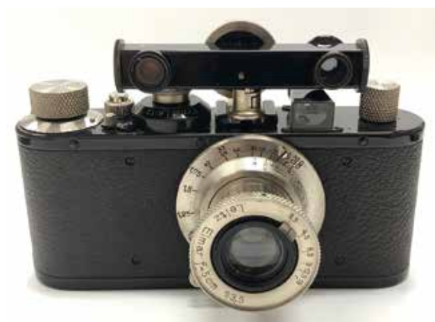
3 ライカスタンダード型 (1936 年製造) 横型距離計取付け。前方に向けた二つの円窓から被写体に向く角度の違いにより測距する。円窓間の距離が距離計の精度に影響する。
