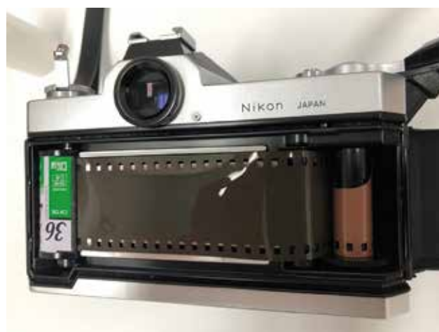
2 右側のスプール（巻き取り軸）にフィルムを差し込み、パーフォレーションが上下の爪にしっかりかかっていること、及びガイドレールから外れていないことを確認する。左上面のフィルム巻き戻しレバーを回転させてフィルムのたるみをなくす。
