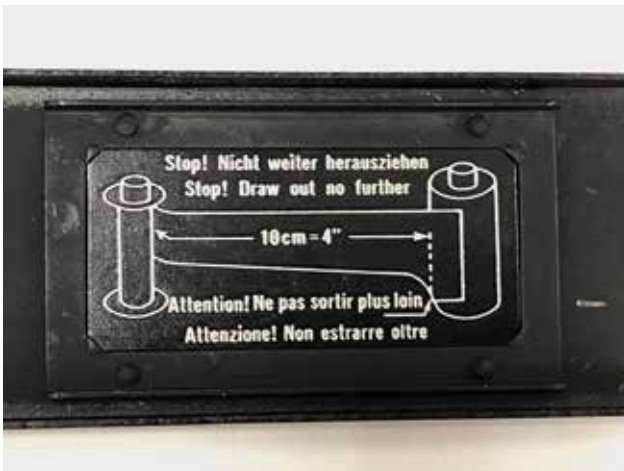
11 底蓋に図示されたようにフィルムの先端部分（ベロ）を切り取って加工する。
