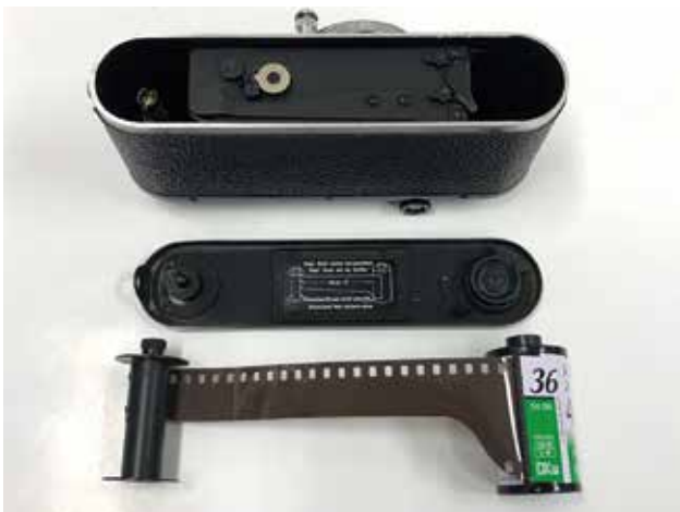
12 フィルム巻き取り用軸にフィルム先端を差し込む。
