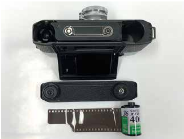
5 底面のカバーを外し、背面の蓋を開く。
