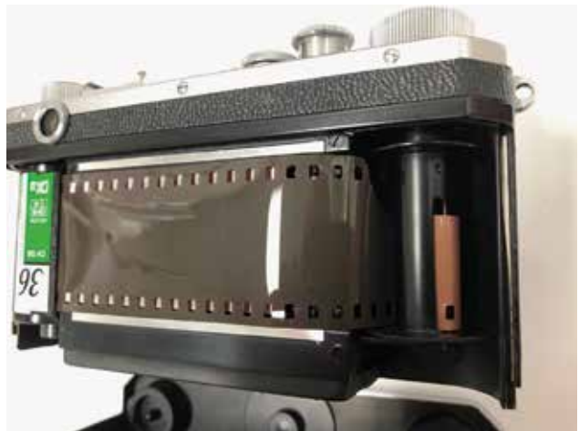
8 スプロケットの上下の爪にフィルムのパーフォレーションがはまっていることを確認する。
