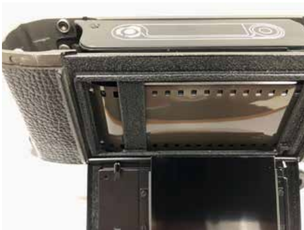
6 フィルムがしっかりスプロケットのスリットに差し込まれ、フィルムガイドレールから外れていないことを確認する。
