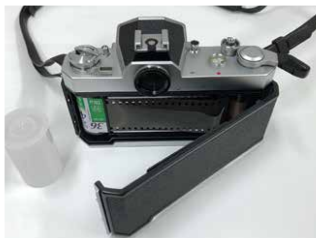
3 裏蓋を開め、右上面のフィルム巻き上げレバーを動かした時、左上面にあるフィルム巻き戻しレバーが回転することを確認する。
