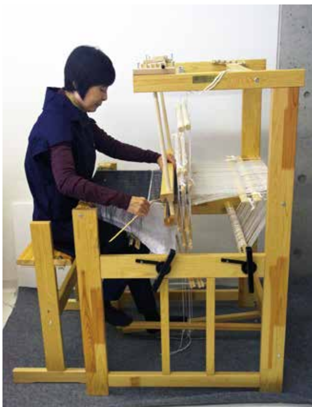
写真3：織機 4枚綜統 ロクロ式 2本ペダル
