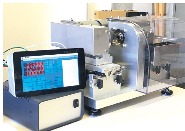
図 11 Raspberry Pi で組んだシステム
