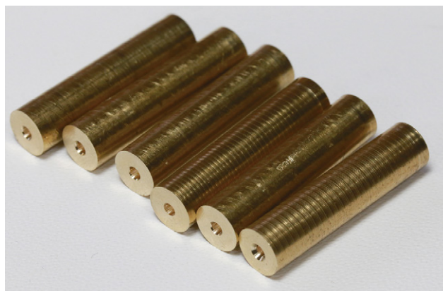
図 14 長さ検証用に切削した真鍮丸棒
