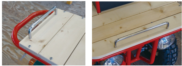
Fig.9 カスタマイズ例 ドアハンドルを用いたストッパ
