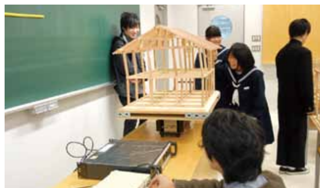
写真8 H24年度 起振装置で揺らす
