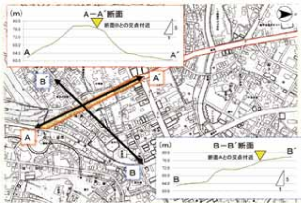
図-4 都市計画道路廃止区間の地形断面 (小千谷市新保氏提供)
