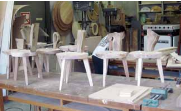
写真4 仮組み立ての様子
