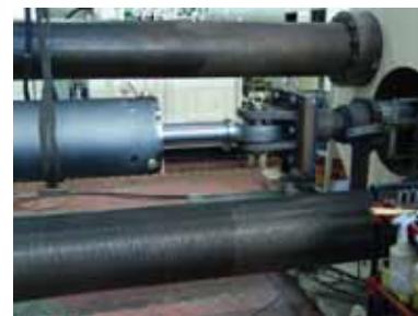
写真 25 水平ダンパー性能確認試験
