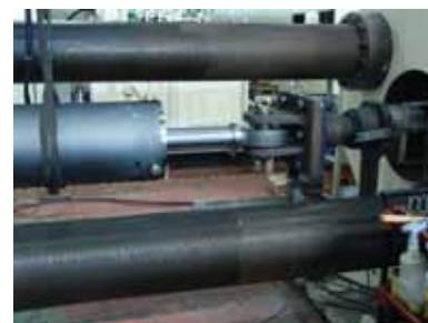
写真 26 ダンパー性能確認試験
