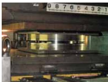
写真 23 支承性能確認試験
