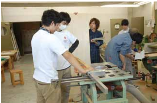
写真9 H25 昇降盤を使ったカット
