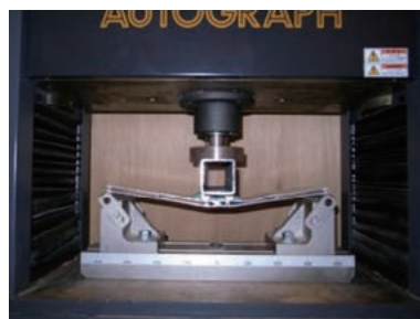
図 曲げ試験
