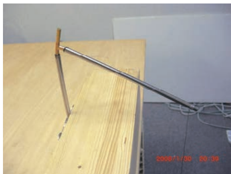
図 接合部強度試験
