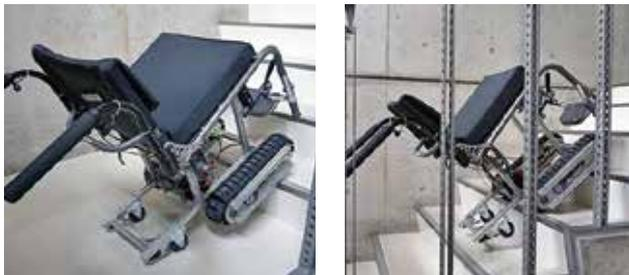
Fig.11 内階段走行実験
