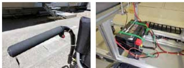
Fig.4 スイッチ位置とバッテリー搭載位置
