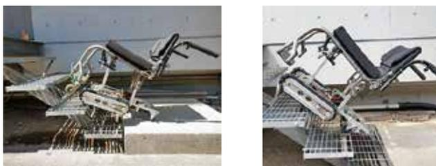
Fig.9 外階段走行実験
