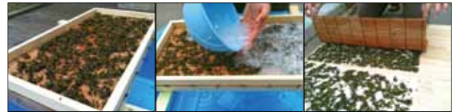
Y-1. 桁にコケを敷き敷き詰める。 Y-2. 和紙の原料を上から流し込む。 Y-3. 裏返すと、コケが露出する。
